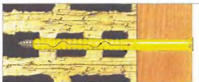
Дюбель для облицовки фасадов из пустотелого кирпича
