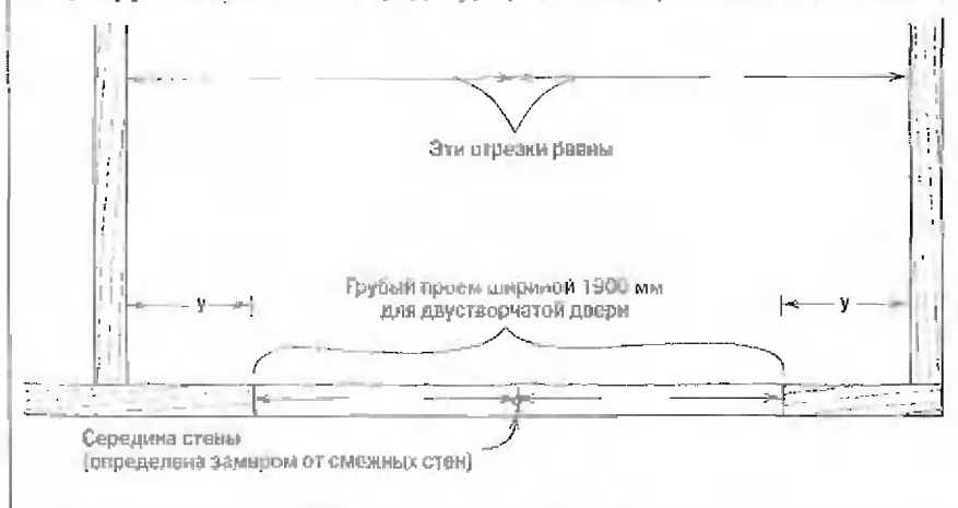
Рис. 3. Разметка грубого проема посередине стены. Лучше не доверять размерам на чертежах, а определить положение грубого проема для двери или окна по центру стены, найдя ее середину, и разметить проем относительно нее
