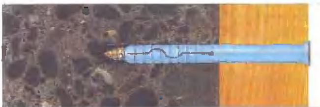
Дюбель для облицовки фасадов из бетона и сплошного кирпича
