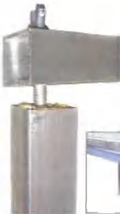
Профиль, шпилька, пробка и гайка-барашек — из этого я изготовил каркас экрана
