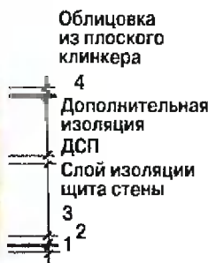
Рис. 7. Наружная стена с облицовкой из плоского клинкера, рассматриваемая специалистами как наиболее перспективная
